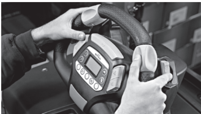
Uniek STILL Easy Drive-stuur voor het beste rijgevoel en bediening van alle functies zonder de handen te hoeven verplaatsen
