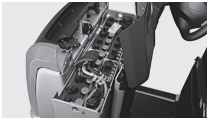
Optionele zijdelingse accuervanging zorgt voor een maximale beschikbaarheid en de beste ergonomie voor de gebruiker
